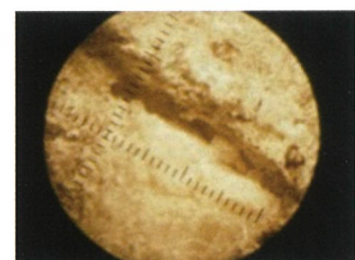
■マトロンルーペによる孔内測定 (目盛り1つが0.1mm)
